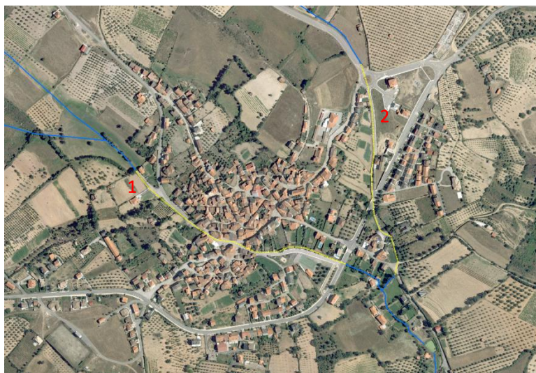
Figura 4: Linhas de água entubadas, na aldeia de Carção (linha de água REN transposta (azul), troço entubado (amarelo))
