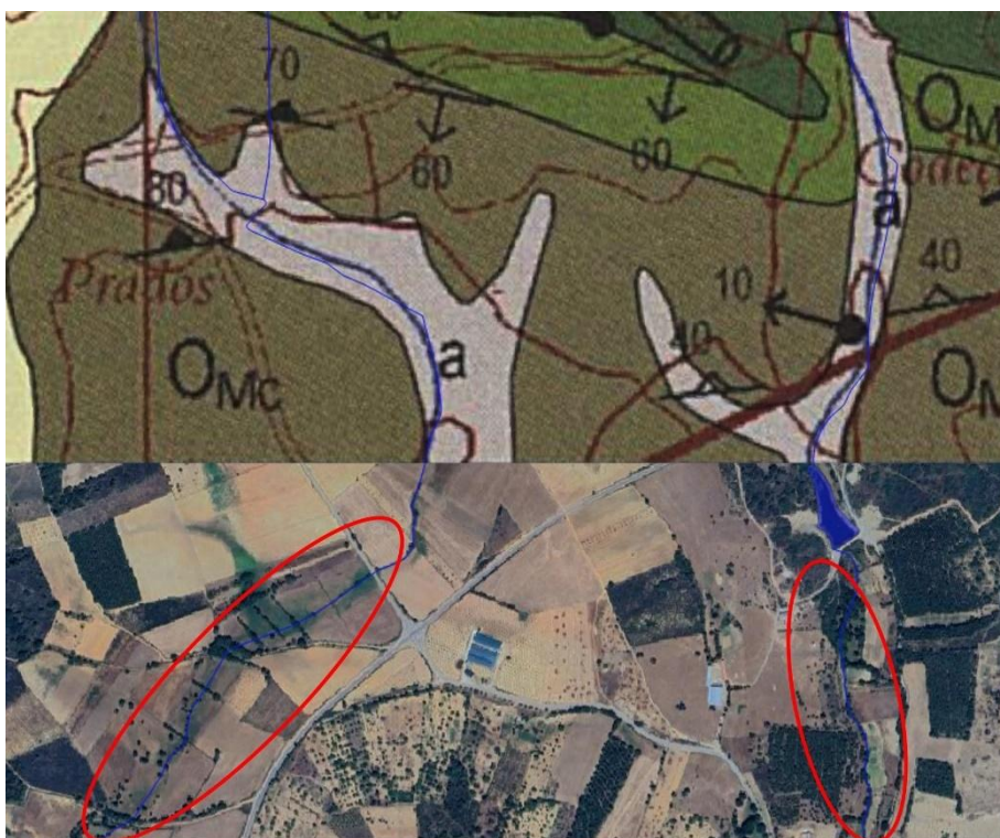
Fig.10 – Continuidade visível no terreno das áreas aluvionares representadas na carta geológica
