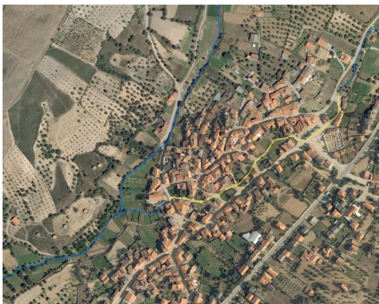
Figura 1: Linha de água entubada, na aldeia de Santulhão [linha de água REN transposta (azul), troço entubado (amarelo)]
