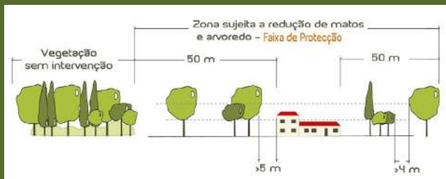
Figura 1 - Exemplo de limpeza de uma faixa de 50 metros associada a um edifício
